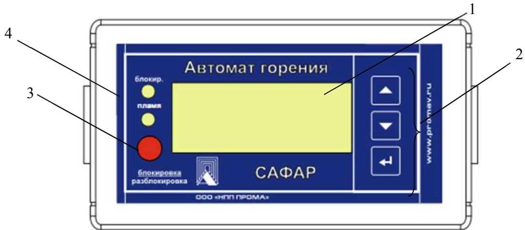
Рисунок 2. Лицевая панель блока управления САФАР. 1 – OLED; 2 – кнопки управления; 3 – кнопка возврата; 4 – светодиоды.
